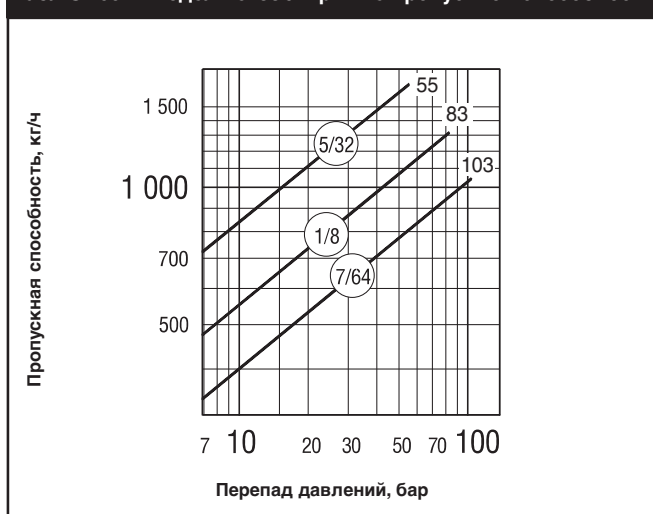
Табл. ST-99-1. Модель 5133G Кривые пропускной способности
