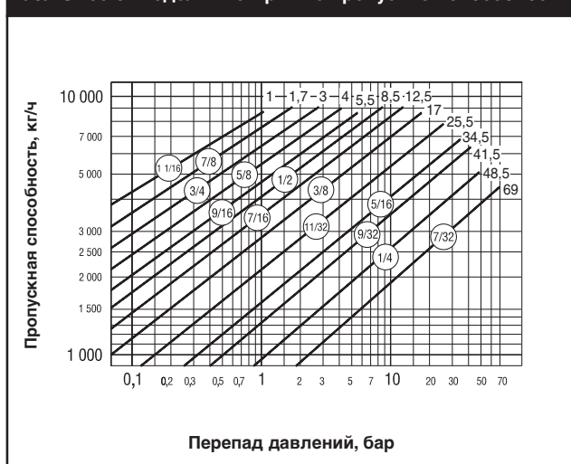
Табл. ST-95-3. Модель 416 Кривые пропускной способности
