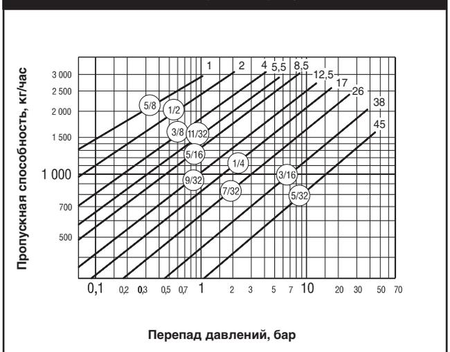
Табл. ST-91-5. Модель 315 Кривые пропускной способности
