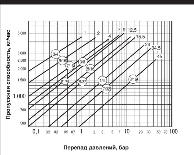
Табл. ST-91-6. Модель 316 Кривые пропускной способности
